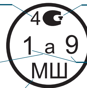
Рисунок 2 - Изображение знака поверки с расшифровкой его содержания
